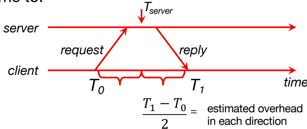
$$T_{new} = T_{server} + \frac{T_1 - T_0}{2}$$
